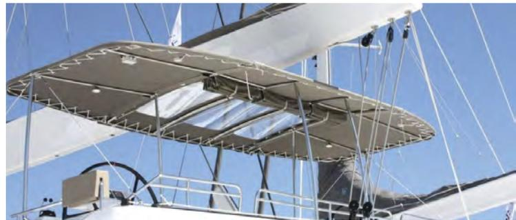
La aplicación práctica de las telas fotovoltaicas ha dado un paso muy importante con la introducción de un toldo bimini que no solo bloquea el sol, sino que también genera suficiente energía para recargar las baterías a bordo o para energizar pequeños aparatos electrónicos. El constructor de catamaranes Lagoon, Dickson-Constant y Nv Equipment presentaron la aplicación durante el Show Internacional de Botes y Yates de Cannes el otoño pasado a bordo del Lagoon 620 de 62 pies de largo.
